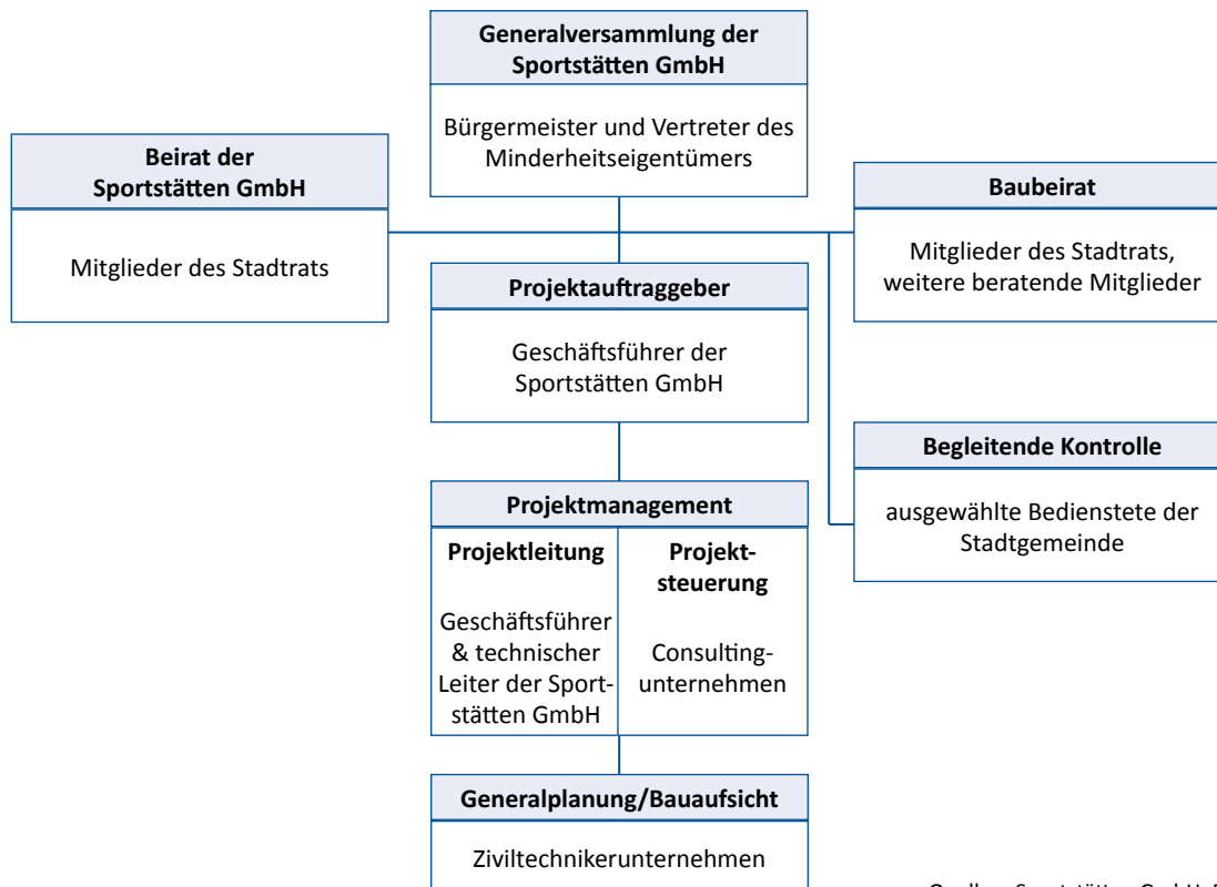
Abbildung 1: Projektorganisation Sanierung Happyland
